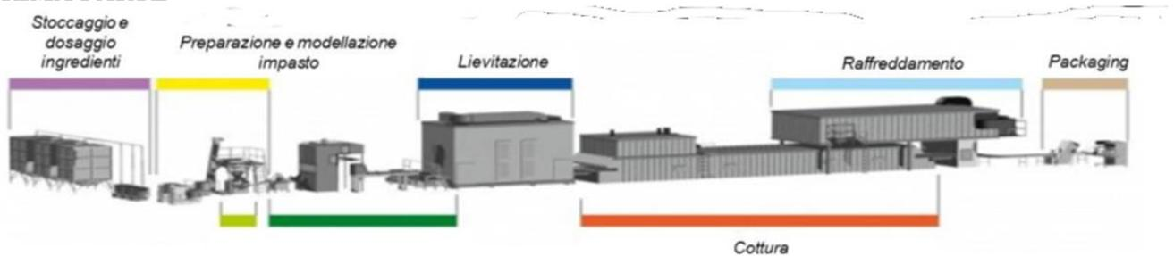
Il processo di produzione di una industria alimentare nella quale vengono preparati e impacchettati prodotti da forno (biscotti) è rappresentato dallo schema riprodotto in figura. In una prima parte del processo avviene il dosaggio delle materie prime e il relativo impasto. L'impasto viene poi modellato, lievitato e cotto in un'altra zona dell'impianto e successivamente i biscotti vengono poi raffreddati e portati verso la zona di impacchettamento.
